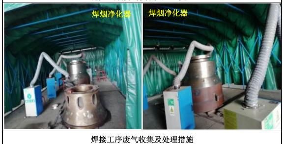
图 3.2-1 本工程废气处理装置现场照片
