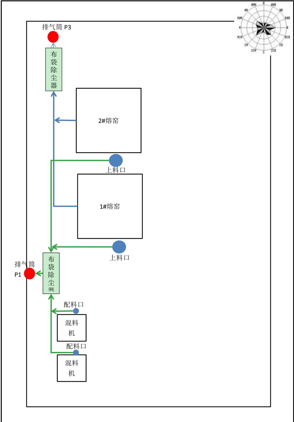
附图 5 项目西厂区集气管道走向示意图
