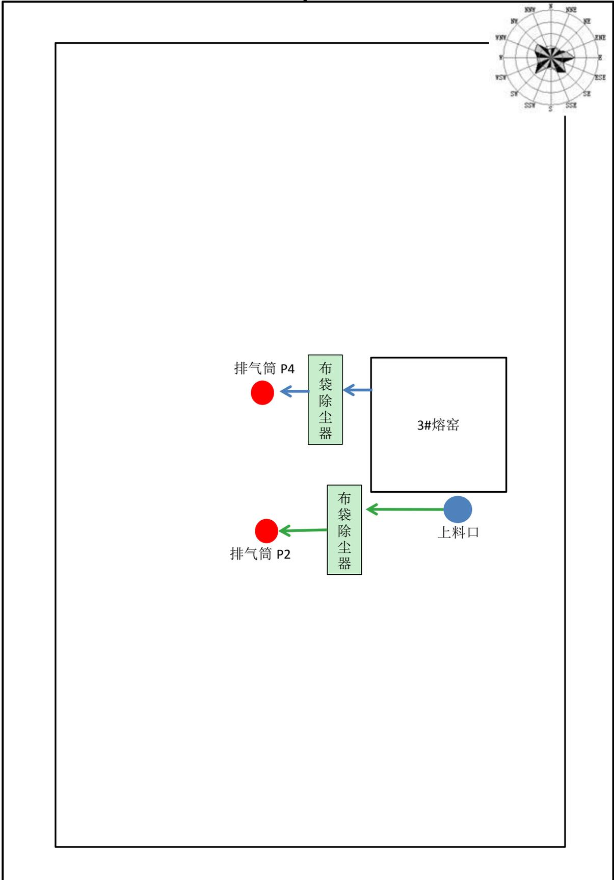
附图 6 项目东厂区集气管道走向示意图
